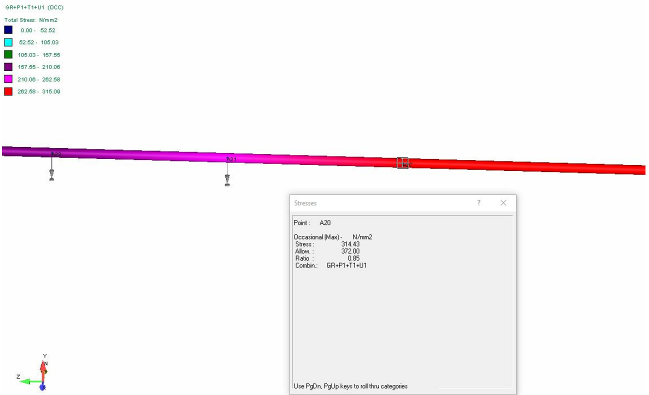
Рисунок 16 – Картина распределения напряжений по Мизесу в районе ПК 36+00 трубопровода от КП9
