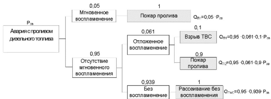
Рисунок 1.1 – «Дерево событий» для аварий с разливом дизельного топлива
