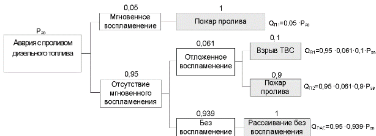
Рисунок 4.6.1 – «Дерево событий» для аварий с разливом дизельного топлива
